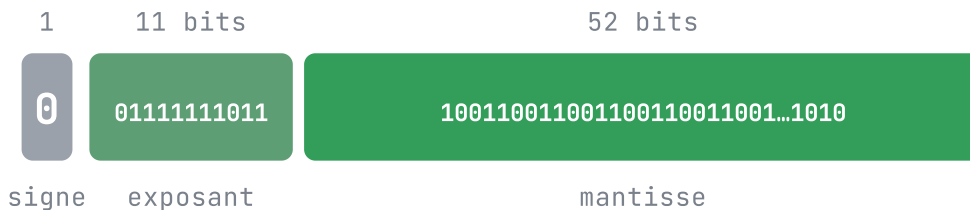
Figure 9 : Un nombre à virgule en mémoire : 64 interrupteurs répartis en trois rôles. Un pour le signe, onze pour l'exposant, cinquante-deux pour les chiffres. C'est là que la place manque et que le motif se coupe (ici, celui de 0.1 ).
